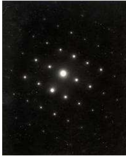
Figure 4.3 – Cliché de diffraction aux rayons X sur un cristal d'alumine (D. Bouchet, Orsay). Les points brillants correspondent aux intersection du réseau réciproque et de la sphère d'Ewald.
