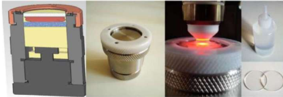
Figure 2.13 : De gauche à droite : schéma en coupe du porte-échantillon où l'on peut voir le piston, l'échantillon en rouge et la fenêtre en blanc. Puis : photo du porte-échantillon hors du système avec la bague de maintien de la fenêtre en plastique blanc. Vient ensuite une photo du porte-échantillon dans le système Light-CT (OCT plein champ LLTech) et finalement à l'extrême droite l'huile silicone faisant le contact optique et une fenêtre en silice isolant l'échantillon du reste du milieu. Figure adaptée de F.Harms 25 .
